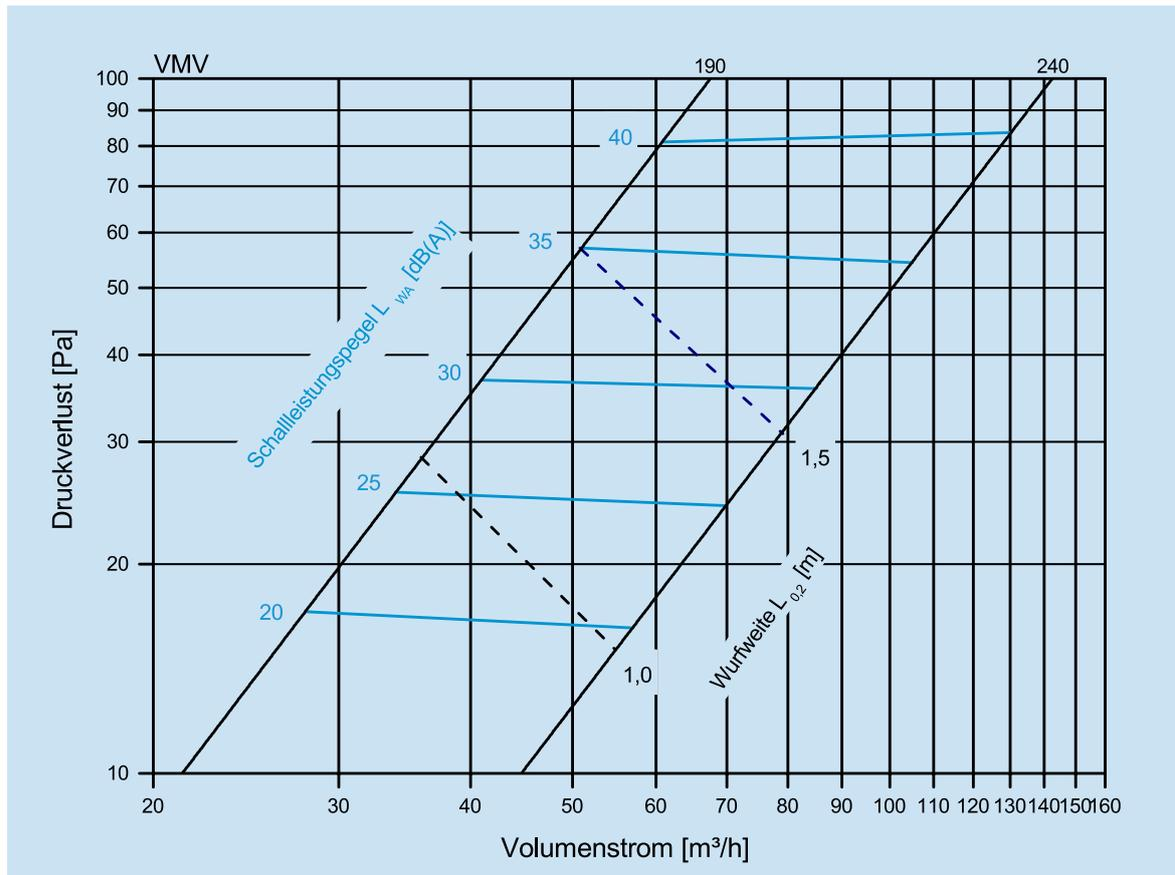
Die Diagrammwerte haben Gültigkeit für die Fußbodendrallauslässe inkl. Schmutzfängerkorb bei horizontalem Drallstrahl und komplett geöffneter Mengeneinstellvorrichtung. Bei Einstellung eines Vertikalstrahles ist der Druckverlust bei gleichem Volumenstrom mit dem Faktor 0,9 zu multiplizieren und der Schallleistungspegel reduziert sich um ca. 5 dB.
