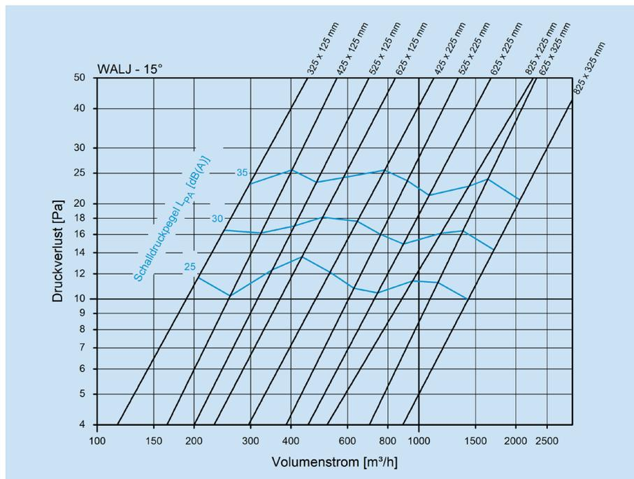
$L_p$ : Schalldruckpegel im Raum gemessen in dB (gemäß NR-Skala) bei 8 dB Raumabsorption und einer Geräuschleistung bezogen auf 10-12 Watt.
