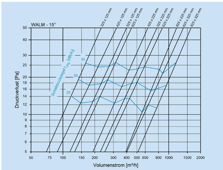
$L_p$ : Schalldruckpegel im Raum gemessen in dB (gemäß NR-Skala) bei 8 dB Raumabsorption und einer Geräuschleistung bezogen auf 10-12 Watt.
