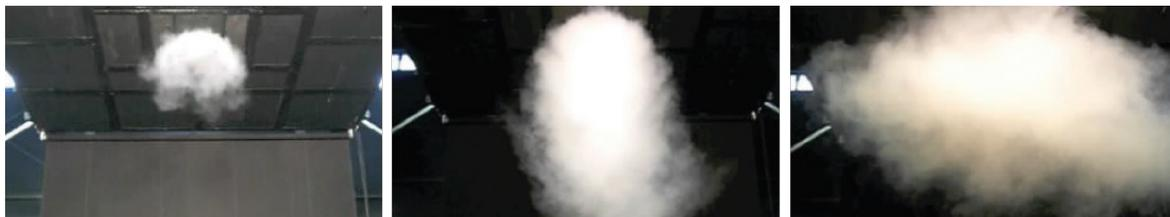
Ist die Lufttemperatur des Raumes identisch mit der Temperatur der eingebrachten Primärluft herrschen isotherme Bedingungen. Der isotherme Fall wird nur für den Luftaustausch verwendet. Zur Einstellung des isothermen Falls werden die Luftleitelemente nur marginal verstellt. Hierbei kann das Strahlprofil der eingeblasenen Luft an eigene Bedürfnisse angepasst werden.
