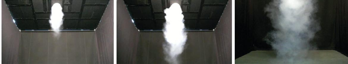
Im Heizfall muss die warme Luft tief in den Raum eingebracht werden, da warme Luft naturgemäß aufsteigt und sich ansonsten entlang der Decke verteilt. Durch das vertikale Einbringen der warmen Luft werden in kürzester Zeit angenehme Raumtemperaturen erreicht. Zur Einstellung des Heizfalls werden die Luftleitelemente minimal abgesenkt (siehe Seite 3).
