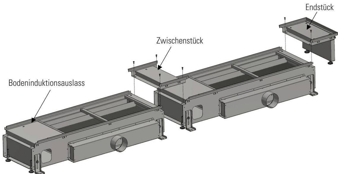
Aufbau der Bandmontage mit Verbindungselemente
