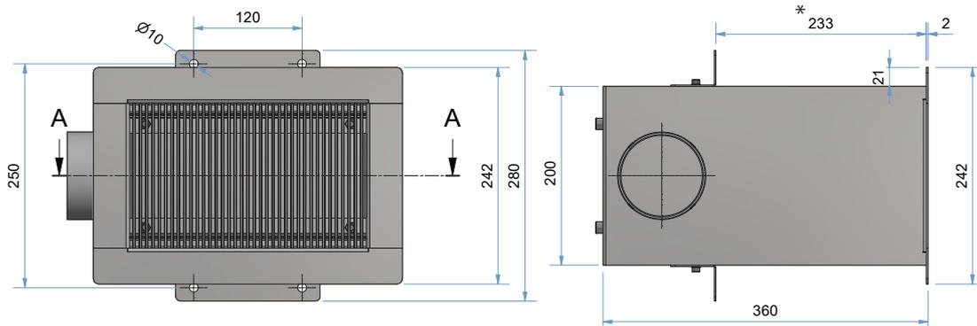
Ausführung mit vertikalem Anschlussstutzen
