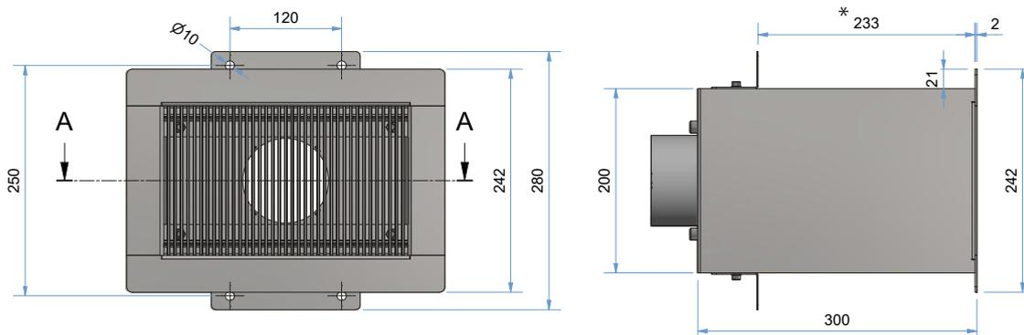
\* Für unterschiedliche Wandstärken ist das Maß durch die integrierten Langlöcher im Befestigungswinkel variabel einstellbar.
